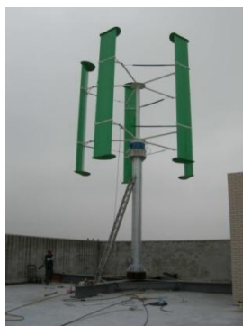
Rys1. Turbina wiatrowa 10kW.
